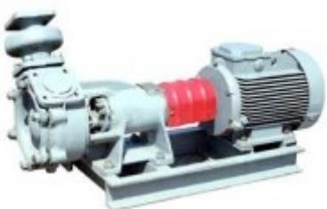
**Электродвигатель снабжается защитой от перегрева, перепадов тока.**
